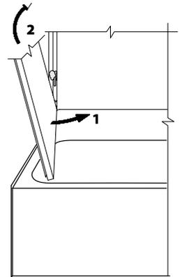
(3) Mantenga la pared lateral completamente calzada pero inclinada para que no se atasque con la válvula de la ducha o niple de la tubería.
